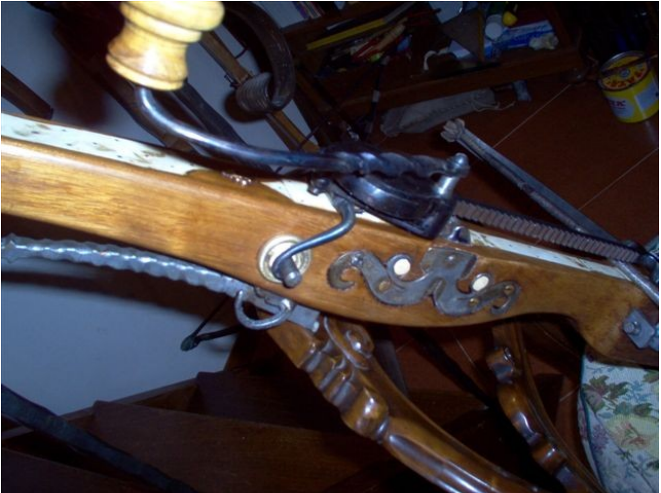
Fig 15 Esempio di aggancio del martinetto ai perni laterali sul teniere.
