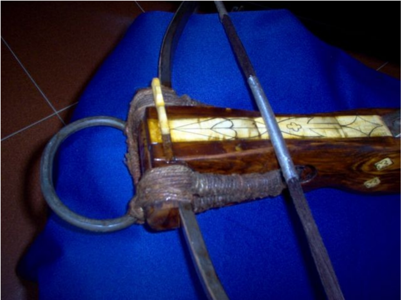
Fig. 7 – 8 - 9 Briglie a vite di serraggio, a zeppe ed a gassa di corda
